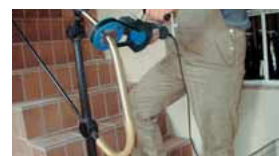
Alu- und Messingrohre reinigen und feinschleifen.
