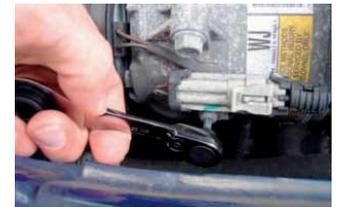
Feinverzahrter Ratschenschlüssel ermöglicht ein Schrauben auf engstem Raum
