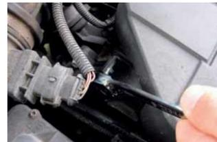
Speziell gekröpfter Ratschenschlüssel mit optimaler Arbeitslänge von 110 mm bzw. 200 mm
