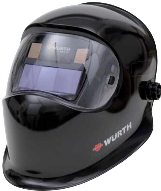
Während die Blendschutzkassette in nicht aktiviertem Zustand die Schutzstufe 3 erreicht, wird bei Aktivierung in Bruchteilen von Millisekunden auf Schutzstufe 11 abgedunkelt.
