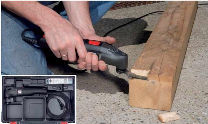
**Universelle, besonders handliche Maschine mit oszillierendem Antrieb. Dadurch sehr schneller Arbeitsfortschritt und gleichermaßen für Schneid-, Schleif-, oder Sägearbeiten geeignet.**
