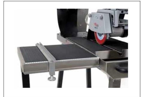
Abb. 4: Ein optionaler Seitentisch mit Anschlag bietet eine sichere Auflegemöglichkeit für großflächige Materialien.
