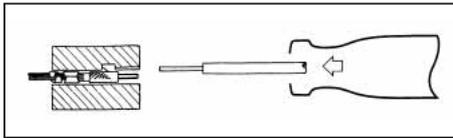
Für Kontakte mit einer Rastzunge/für Gehäuse mit einer Rastzunge
