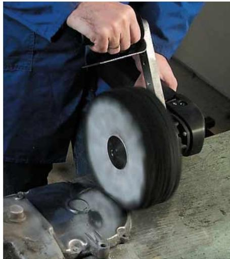
**Durchzugsstarke Polier- und Satiniermaschine in kleiner, handlicher Bauform.**
