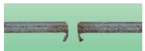
Zum Vergleich: Gratabbildung bei handelsüblichen 1,0-mm-Trennscheiben
