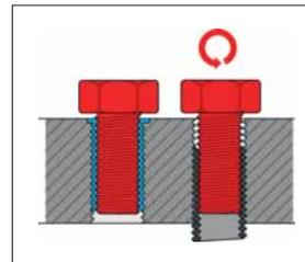
**TIME-SERT hat einen Bund, der eine genaue Positionierung im Werkstück gewährleistet.**
