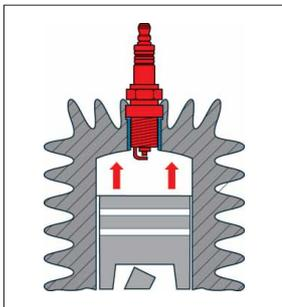
**TIME-SERT ist mediendicht durch die Verpressung mit dem Werkstück.**
