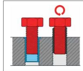
**TIME-SERT ist selbstsichernd durch das automatische Ausformen der nicht voll ausgebildeten Gewindegänge beim Eindrehen.**
