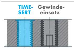
**TIME-SERT ist sehr dünnwandig durch synchron verlaufende Gewindegänge.**
