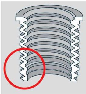
**Das TIME-SERT-System** basiert auf einer massiven Stahlbuchse, die aus einem Vollmaterial spanend hergestellt wird. Die dünnwandige Buchse wird mit dem Werkstück verpresst, daher eignet sich TIME-SERT für hohe Dauerbelastungen sowie für häufiges Ein- und Ausschrauben.
