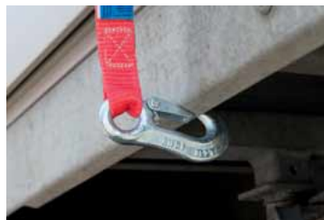
Vergleich: Karabiner bietet keinen optimalen Halt
