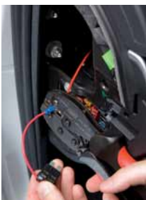
Verbraucher an Flachsteck sicherungshalter anschließen
