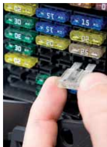
Vorhandene Flachstecksicherung aus dem Sicherungssockel entnehmen
