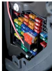
Flachstecksicherungshalter in vorhandenen Sicherungssockel stecken
